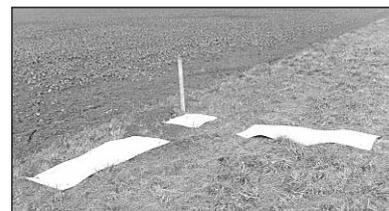
*Die Signalisierung für Passpunkte besteht aus rechtwinklig zueinander angeordneten weißen Plastikfolien (ca. 1,4 m x 0,5 m)*
